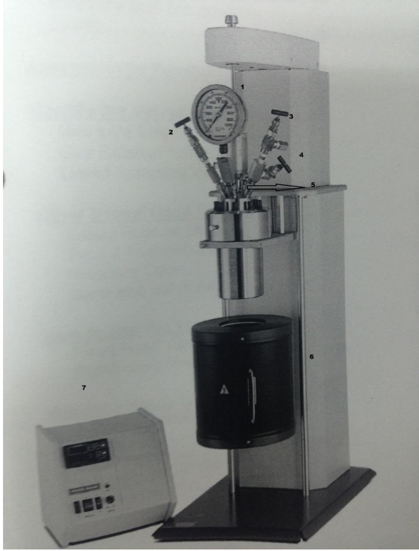
Şekil 3.1. Deneylerde kullanılan yüksek sıcaklık ve basınç reaktörü 1) Manometre 2) Gaz giriş vanası 3) Gaz çıkış vanası 4) Sıvı numune alma vanası 5) Termo çift (thermocouple) 6) Isıtıcı 7) Kontrolör
