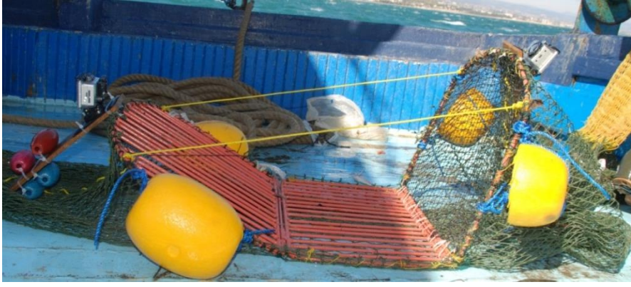
Şekil 3.2.10. JTED kaçış boşluklarına donatılmış GoPro Hero ve GoPro Hero 2.
