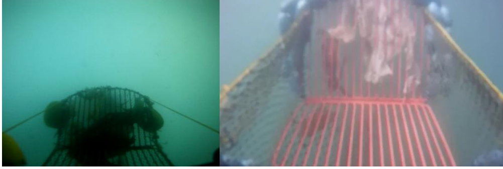
Şekil 4.2.11. JTED ızgarasını bloke eden çöpler.
