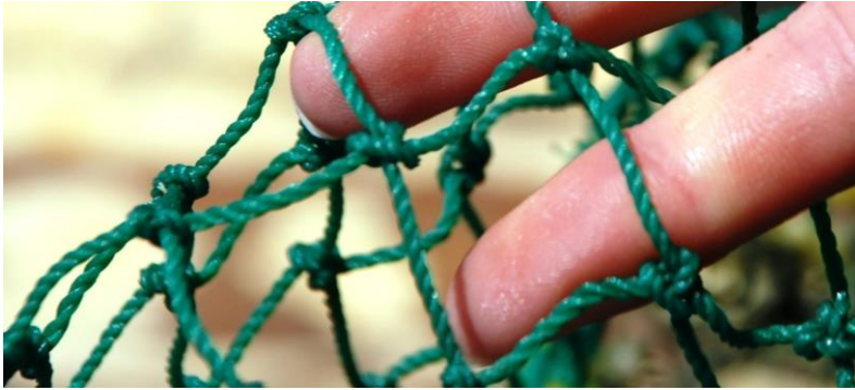
Şekil 3.1.5. Deneysel torbaların yapımında kullanılan PE fabrikasyon ağ.
