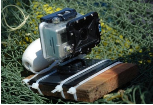
Şekil 3.2.8. Izgaranın önüne ahşap materyalle sabitlenmiş GoPro Hero 2.
