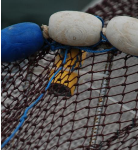
Şekil 3.2.9. Kablo kelepçesiyle ızgaranın üzerine sabitlenmiş RD32.
