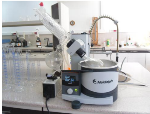
Şekil 3.4. Karotenoid madde analizinde kullanılan rotary evaporatör
