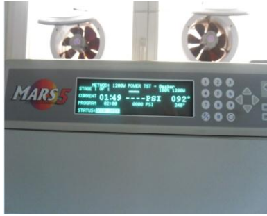
Şekil 3.11. Mikrodalgada haşlama analizinde kullanılan laboratuvar ölçekli mikrodalga
