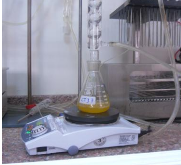
Şekil 3.6. Fenolik asit analizinde kullanılan geri soğutucu ve santrifüj
