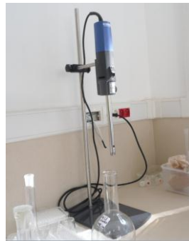
Şekil 3.2. Karotenoid madde ekstraksiyon analizinde kullanılan homojenizatör ve ayırma hunileri
