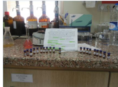
Şekil 3.7. Fenolik asit analizinde hazırlanan fenolik asit standartları ve domates ekstraktları
