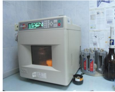
Şekil 3.11. Mikrodalgada haşlama analizinde kullanılan laboratuvar ölçekli mikrodalga
