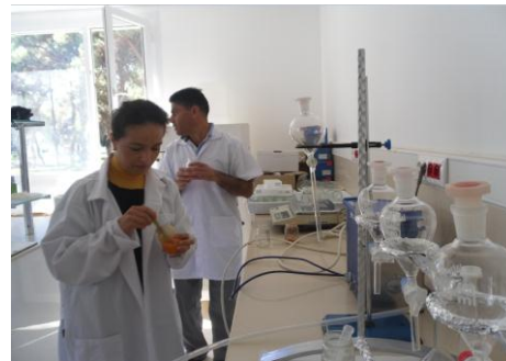
Şekil 3.2. Karotenoid madde ekstraksiyon analizinde kullanılan homojenizatör ve ayırma hunileri
