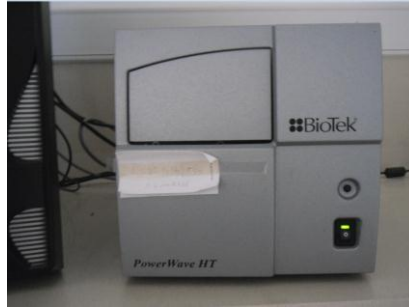
Şekil 3.10. Enzim aktivitesi analizinde kullanılan spektrofotometre
