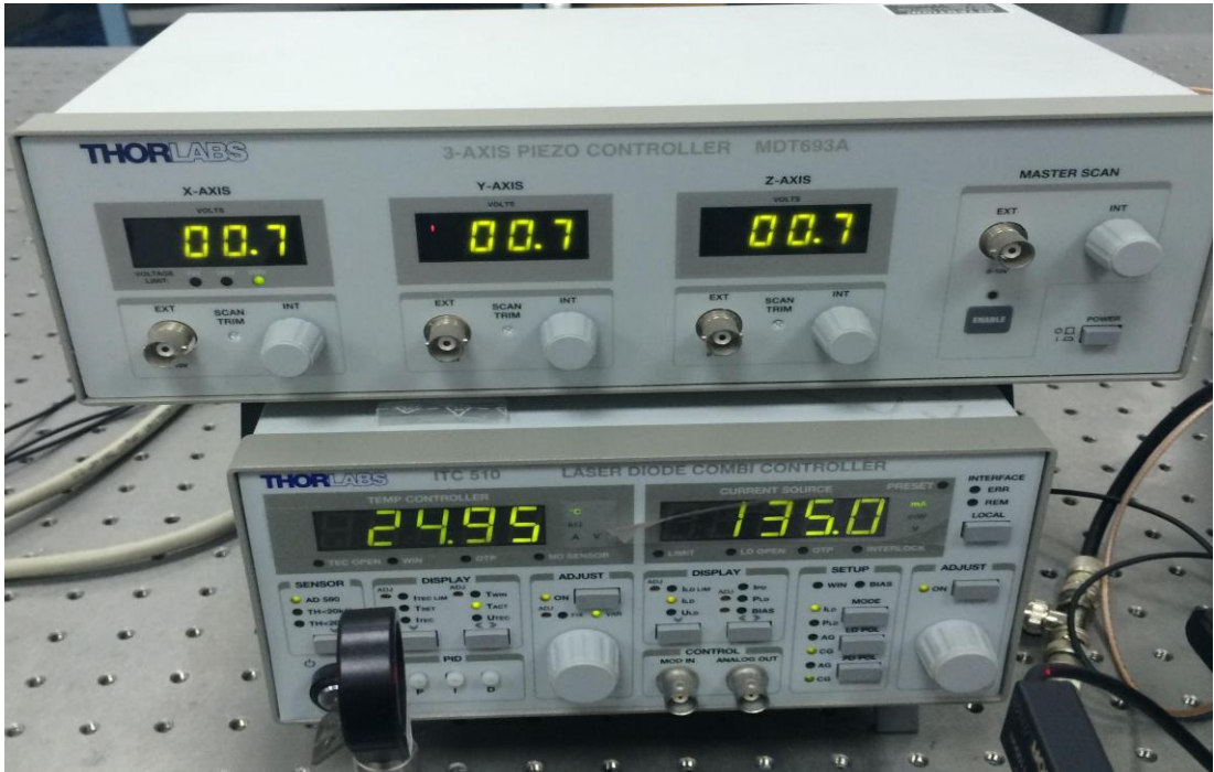
Şekil 3.15. Mersin Üniversitesi Fen Edebiyat Fakültesi Fizik Bölümü Lazer Laboratuvarı'nda kurulan HOSDL sisteminde kullanılan Piezo güç kaynağı (Thorlabs MDT693A) ile lazer kafasının akım ve sıcaklık kontrol cihazı (Thorlabs ITC510).
