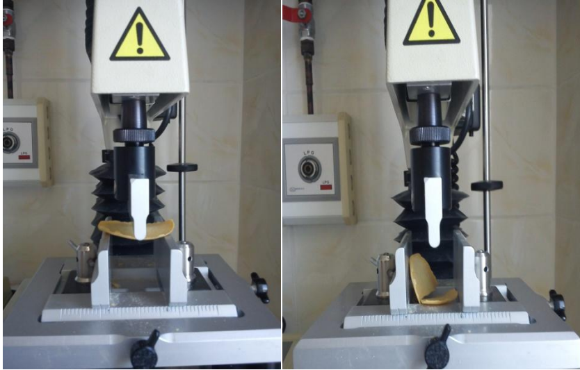
Şekil 3.4. Dokusal analiz cihazı ve üçlü bükme testi donanımı
