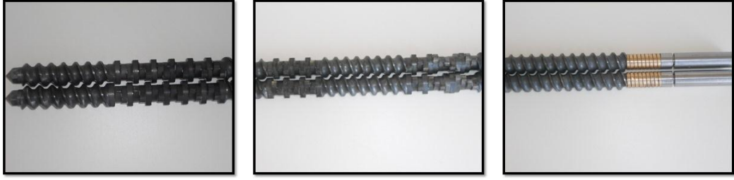
Şekil 3.4. Üretimde kullanılan vidanın konfigürasyonu
