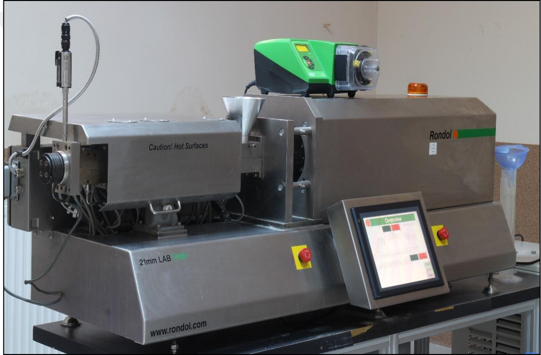
Şekil 3.2. Çift-vidalı gıda ekstrüderi
