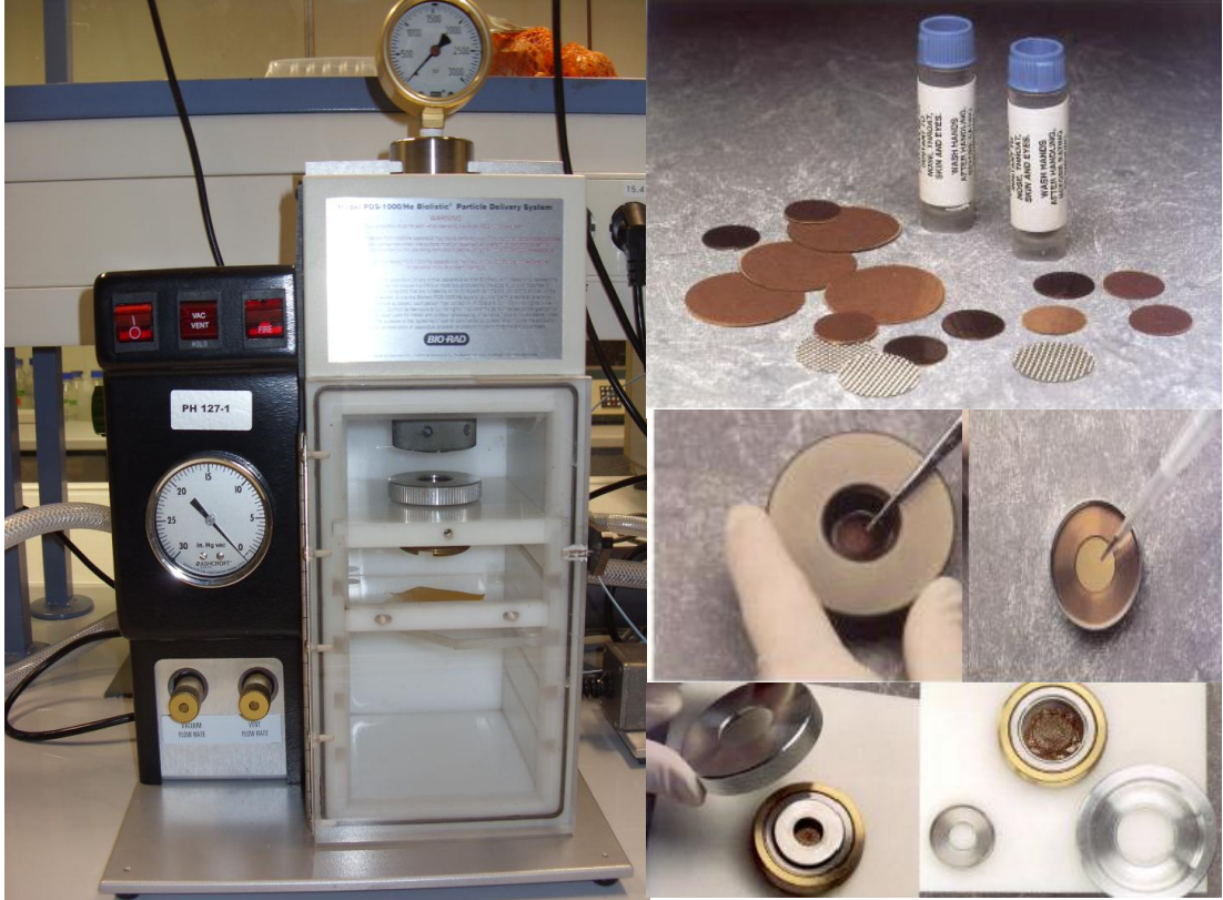
Şekil 3.15. Denede kullanılan biyolistik cihazı va parçaları. Biyolistik, biyolojik ve balistik kelimelerinin kısaltmalarının birleştirilmesi şeklinde adlandırılan, hücrelerin DNA ile kaplı hızlandırılmış mikro taşıyıcılarla transfer edilmesinde kullanılan bir cihazdır.
