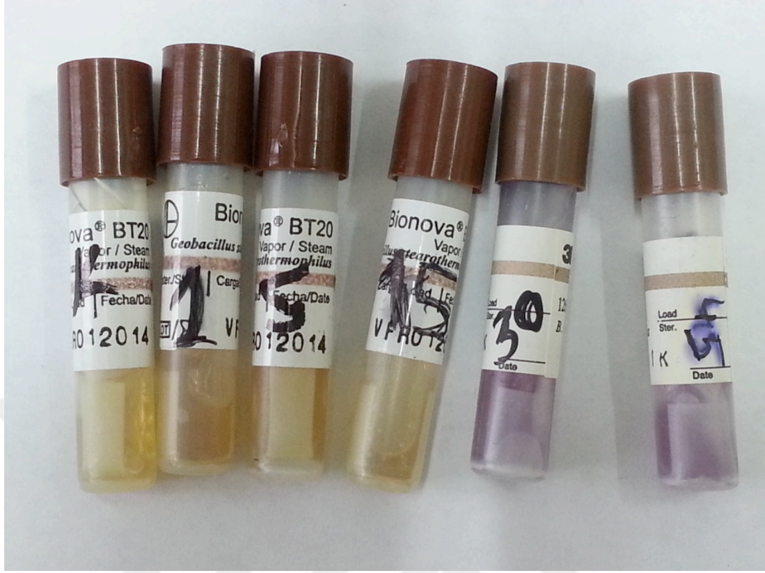
Şekil 5.1. Sterilizasyon işlemi sonrası indikatördeki renk değişimi
