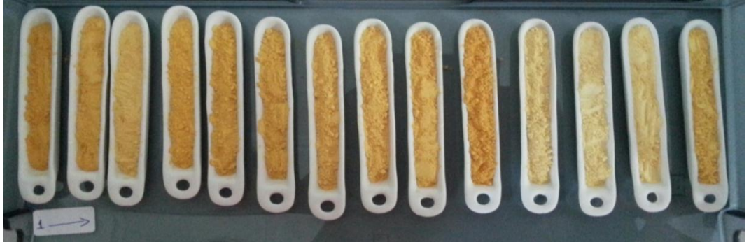
Şekil 3.4. Isıl işlemde önce krozelere konulan numuneler
