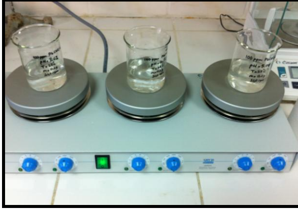
Şekil 3.8. Başlangıç pH değerlerinin adsorpsiyona etkisinin incelendiği deney düzeneği
