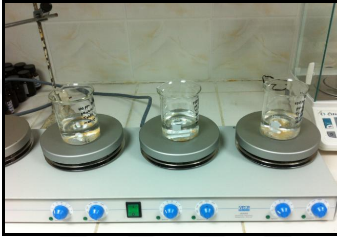
Şekil 3.7. Temas süresinin adsorpsiyona etkisinin incelendięi deney düzeneęi
