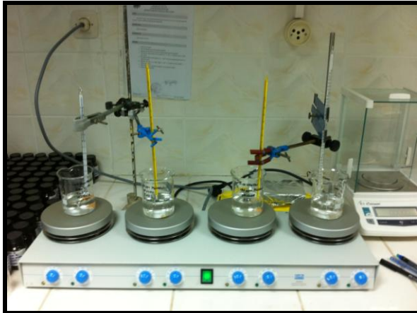
Şekil 3.9. Sıcaklığın adsorpsiyona olan etkisinin incelendiği deney düzeneği
