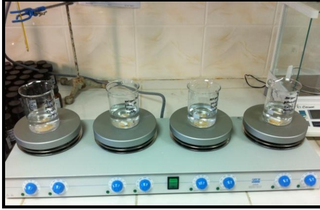
Şekil 3.11. Başlangıç kurşun (II) derişiminin adsorpsiyona etkisinin incelendiği deney düzeneği
