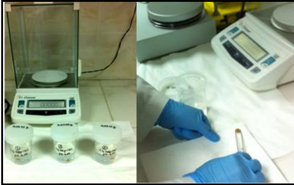
Şekil 3.3. HAp/Jel kompozit hidrojellerinin % şişme testlerinin yapılışı
