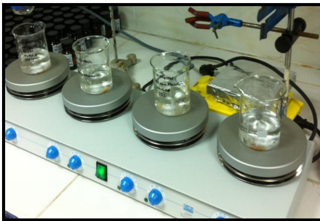
Şekil 3.12. Adsorbent derişiminin adsorpsiyona etkisinin incelendiği deney düzeneği
