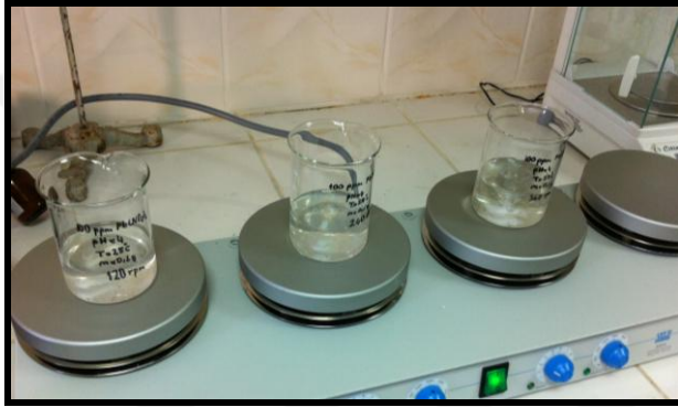
Şekil 3.10. Karıştırma hızının adsorpsiyona olan etkisinin incelendiği deney düzeneği
