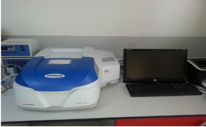
Şekil 3.6. Çalışmamızda kullanılan Analytik Jena Specord 210 Plus model UV-Vis Absorbsiyon Spektrofotometresi.
