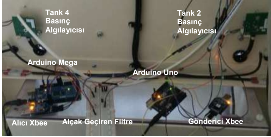
Şekil 3.6. Algılayıcı verilerinin kablosuz iletimi için oluşturulan sistem
