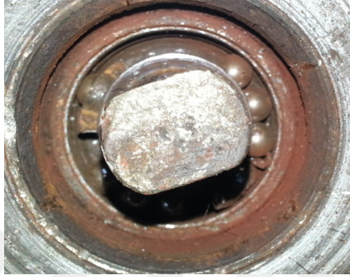
Şekil 2.26. Korozyona uğramış hasarlı bir rulo rulmanı
