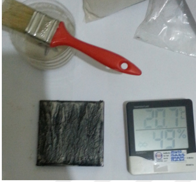
Şekil 4.48. Kirli bant numunesinin hazırlanmasından bir görünüm
