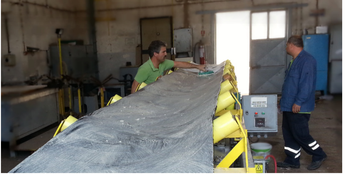
Şekil 4.59. Bant üst şeridi suni olarak kirletilirken
