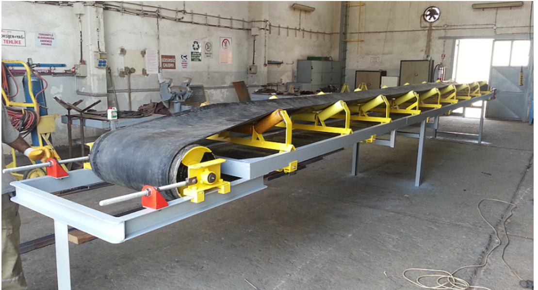
Şekil 3.1. Yıkama sistemi için imalatı yapılan konveyör bant
