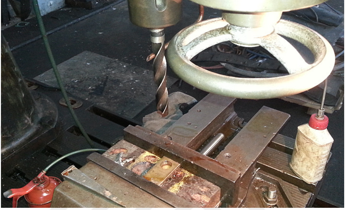
Şekil 4.28. Mafsal parçası (Poz-21_5A1) talaşlı imalatından bir görünüm
