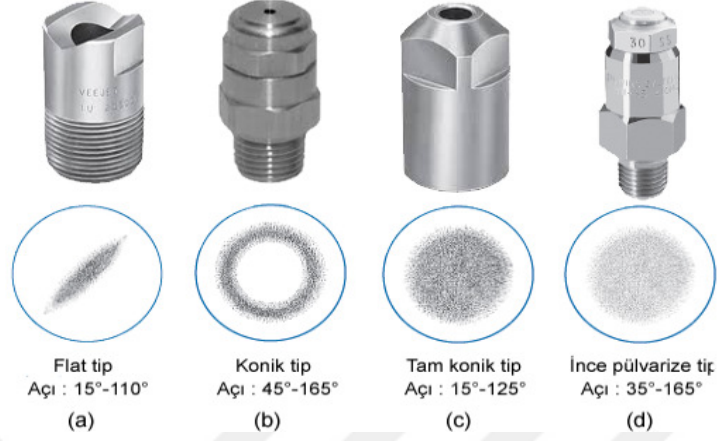
Şekil 3.32. Nozul tipleri ve daire içerisinde gösterilmiş püskürtme alanları
