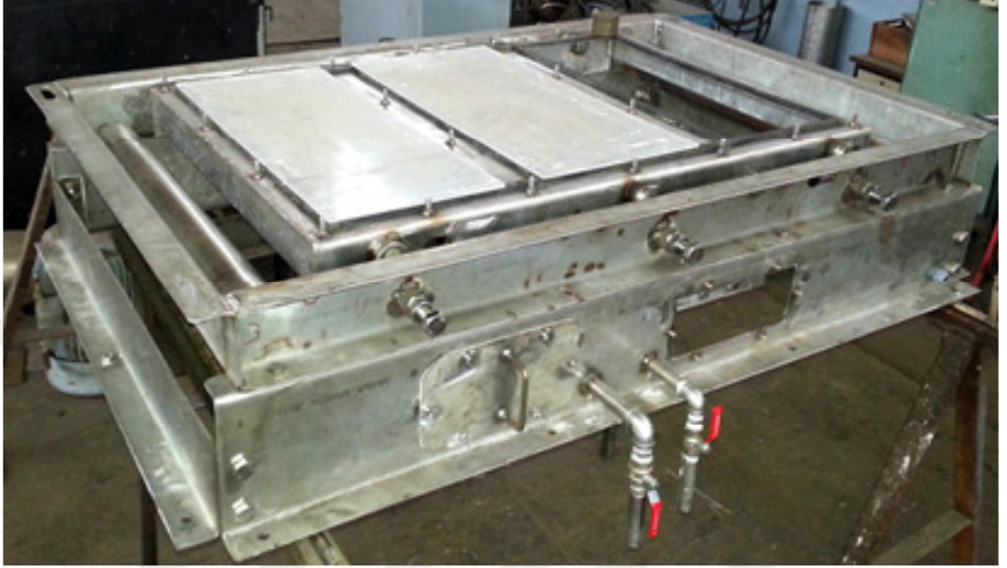
Şekil 4.37. Ön montajı yapılan sistemin ölçü ve ayarların kontrol edilmesi
