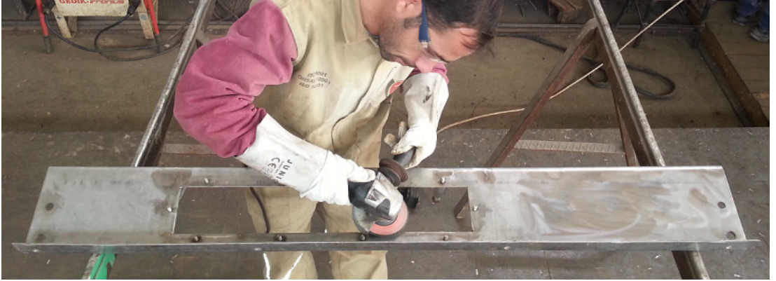
Şekil 4.26. Alt grup şasi sol parçası (Poz-21_3A2) imalatından bir görünüm
