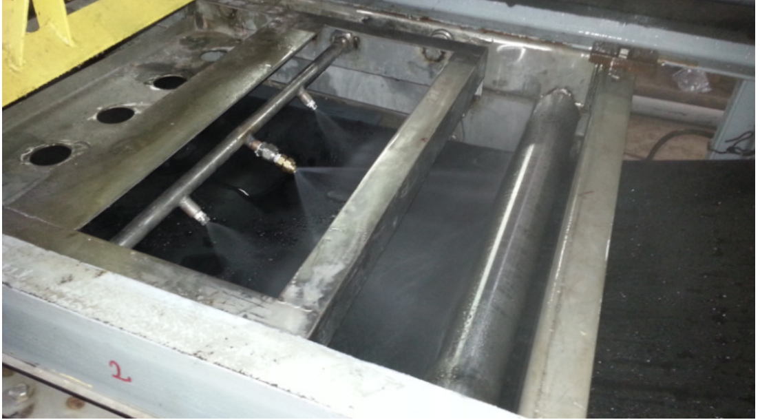
Şekil 4.52. Muhafaza kapağının açılarak bant alt şerit yıkamasından alınan fotoğraf
