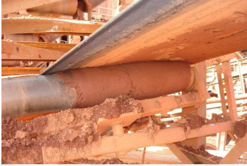
Şekil 2.28. Geri taşınım etkisi ile birikim yapan rulo [40]
