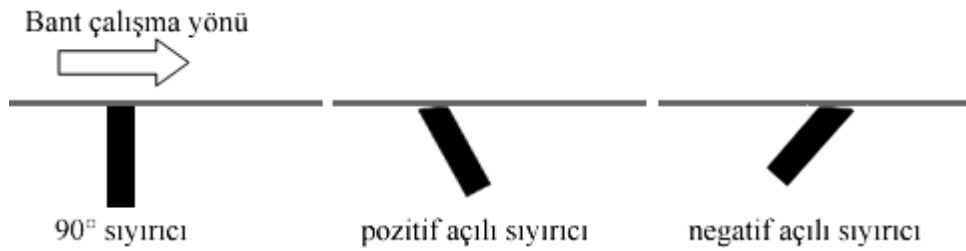
Şekil 2.33. Bant sıyırıcılarının açılara göre gösterimi
