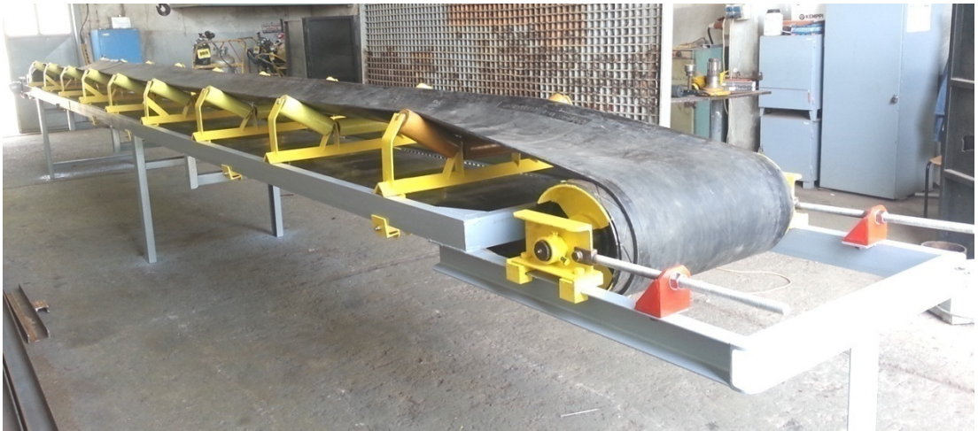
Şekil 3.25. İmalatı ve montajı tamamlanan bantlı konveyör
