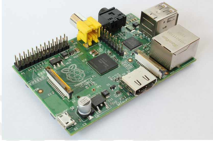
Şekil 3.6. RaspberryPi-Model B genel görünüş
