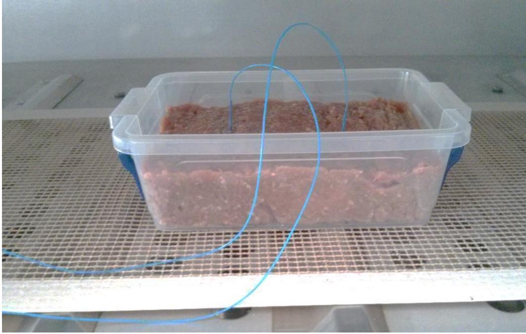
Şekil 3.8. Polipropilen bir kutu içerisine yerleştirilerek dondurulmuş örnek ve içerisine yerleştirilmiş fiber-optik problemler.
