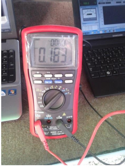
Şekil 3.6. Kayıt tutabilen dijital akım ve gerilim ölçer
