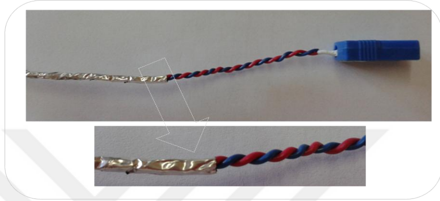
Şekil 3.5. Kullanılan ısıtıcı çiftlerin yapısı
