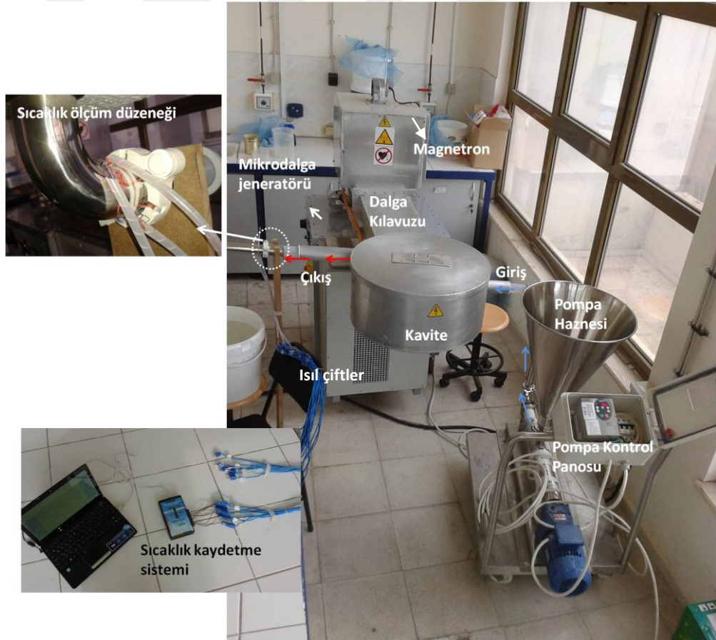
Şekil 3.2. Helikal boru konfigürasyonlu sürekli akış mikrodalga sistemin deney düzeneđi
