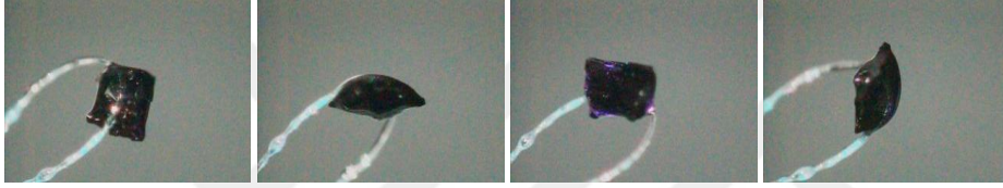
Şekil 5.18. Difraktometre üzerindeki K[Et_4N][Co(HL^2)_2] kristalinin görüntüsü.
