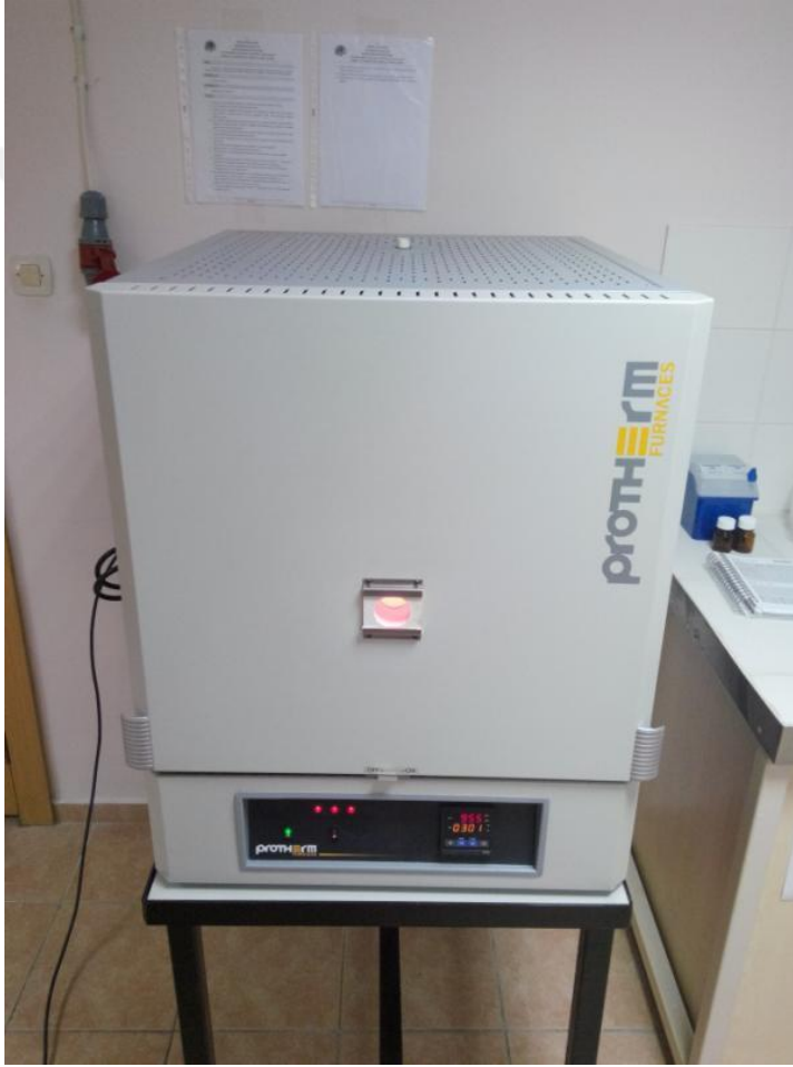
Şekil 3.5. Katkısız HA ve bor katkılı HA pelletlerin sinterlenme aşamasında kullanılan fırını
