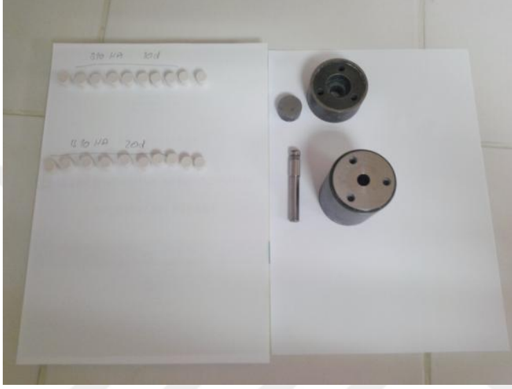
Şekil 3.3. Üretilen tozları pellet haline getirmek amacıyla kullanılan kalıp
