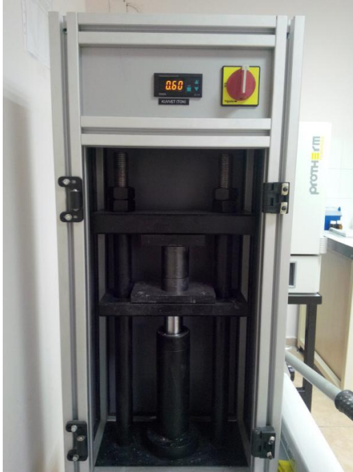
Şekil 3.4. Üretilen tozları pellet haline getirmek amacıyla kullanılan tek eksenli pres
