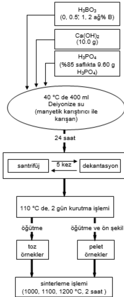
Şekil 3.2. Tez kapsamında üretimi yapılan katkısız HA ve bor katkılı HA tozlarının sentezlenme aşamasını gösteren akış şeması
