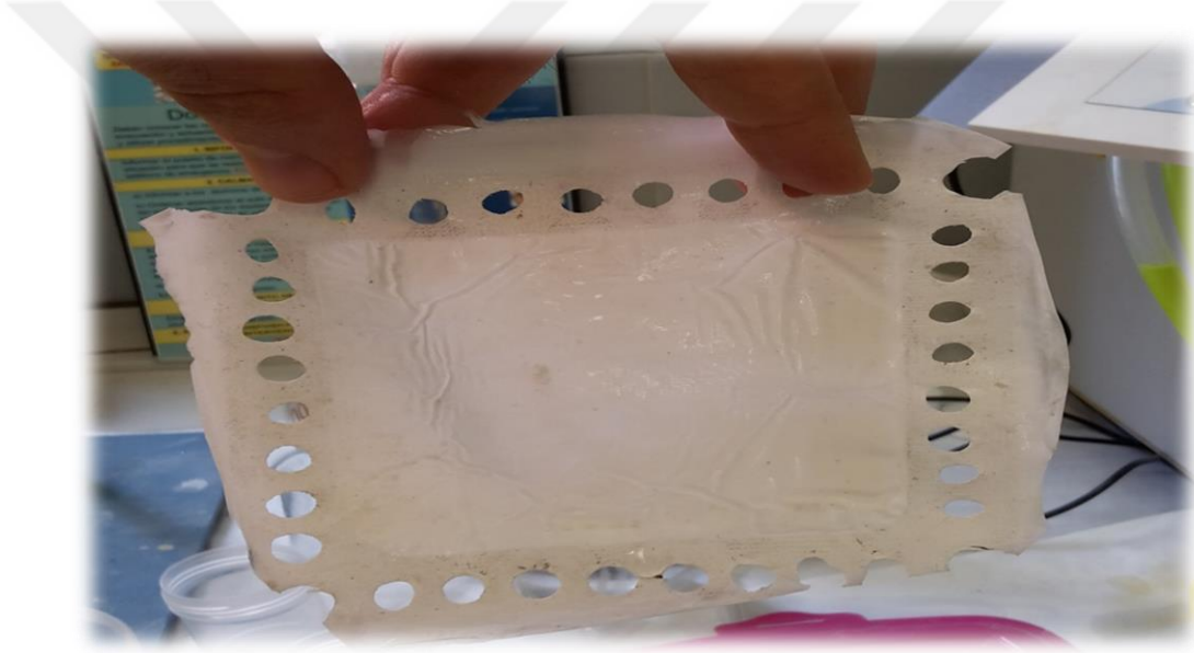
Şekil 3.11. M3 kodlu TiO 2 katkılı sentezlendikten sonra hemen aktifleştirilen Nafion membranın görünümü
