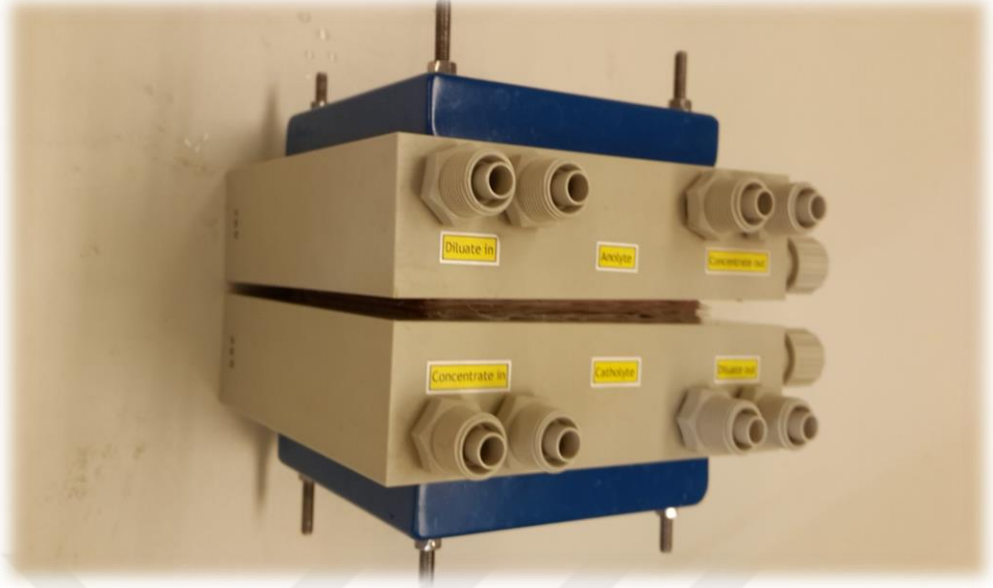
Şekil 3.8. Elektrokimyasal dezenfeksiyon (elektroliz-elektrodiyaliz) hücresinin montajlı görünümü
