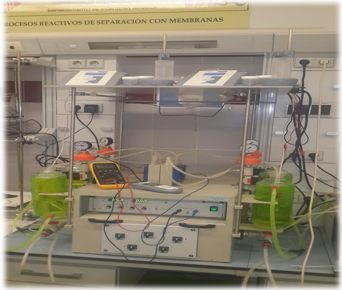
Şekil 3.2. Elektrokimyasal dezenfeksiyon sisteminin fotoğrafı (elektroliz-elektrodiyaliz)
