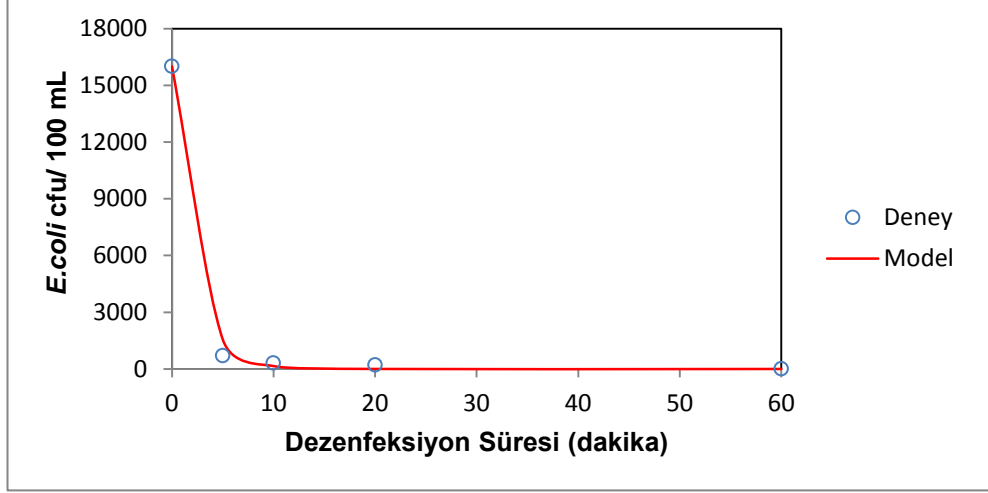
Şekil 4.56. E.coli giderimi için elde edilen dezenfeksiyon kinetiği modelinin deney verileri ile karşılaştırılması
