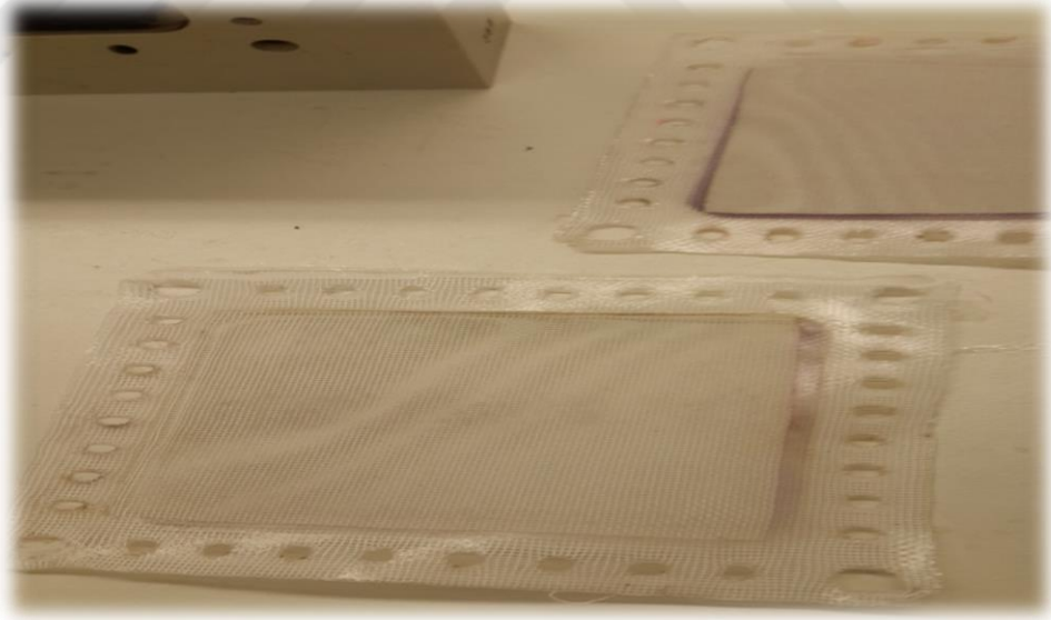
Şekil 3.6. Boşluk sağlayıcı yapılar
