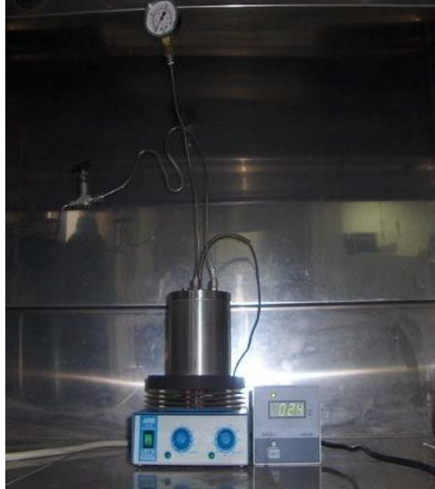
Şekil 3.5. IHO Sistemi (Yüksek Basınç Reaktörü, Isıtıcı ve Termometre) [48].
