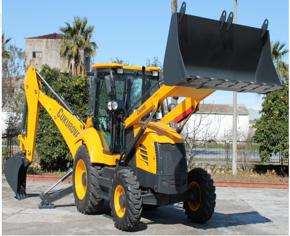
Şekil 1.1. Çukurova 880 Model Backhoe Loader
