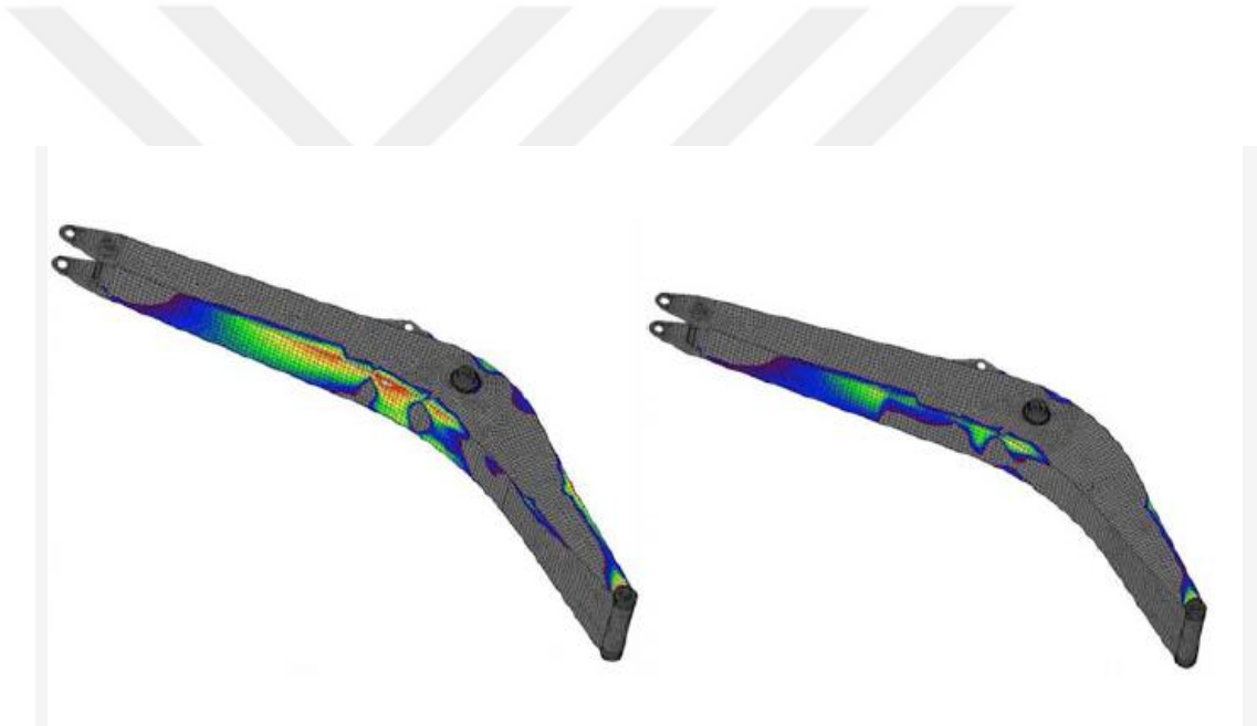
Şekil 2.7. Von Mises Stres Dağılımı İlk Tasarım ve İyileştirilmiş Tasarım
