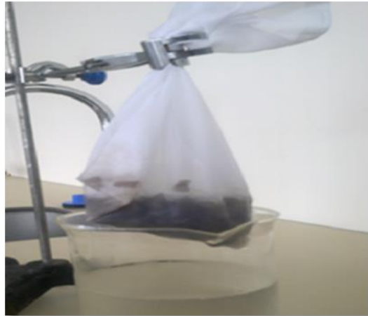
Şekil 3.3. Deri ve çözeltiden oluşan karışımın filtre edilmesi
