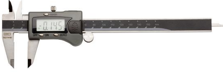
Şekil 3.7. Çap ve kalınlık ölçümünde kullanılan elektronik kumpas
