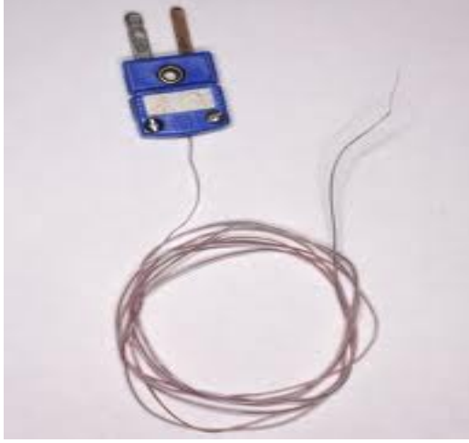
Şekil 3.2. Sıcaklık ölçümünde kullanılan T-tipi ısı çift
