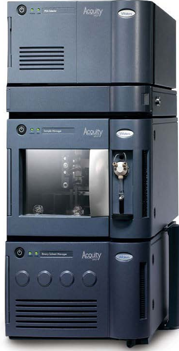
Şekil 3.14. Akrilamid analizinde kullanılan LC-MS cihazı
