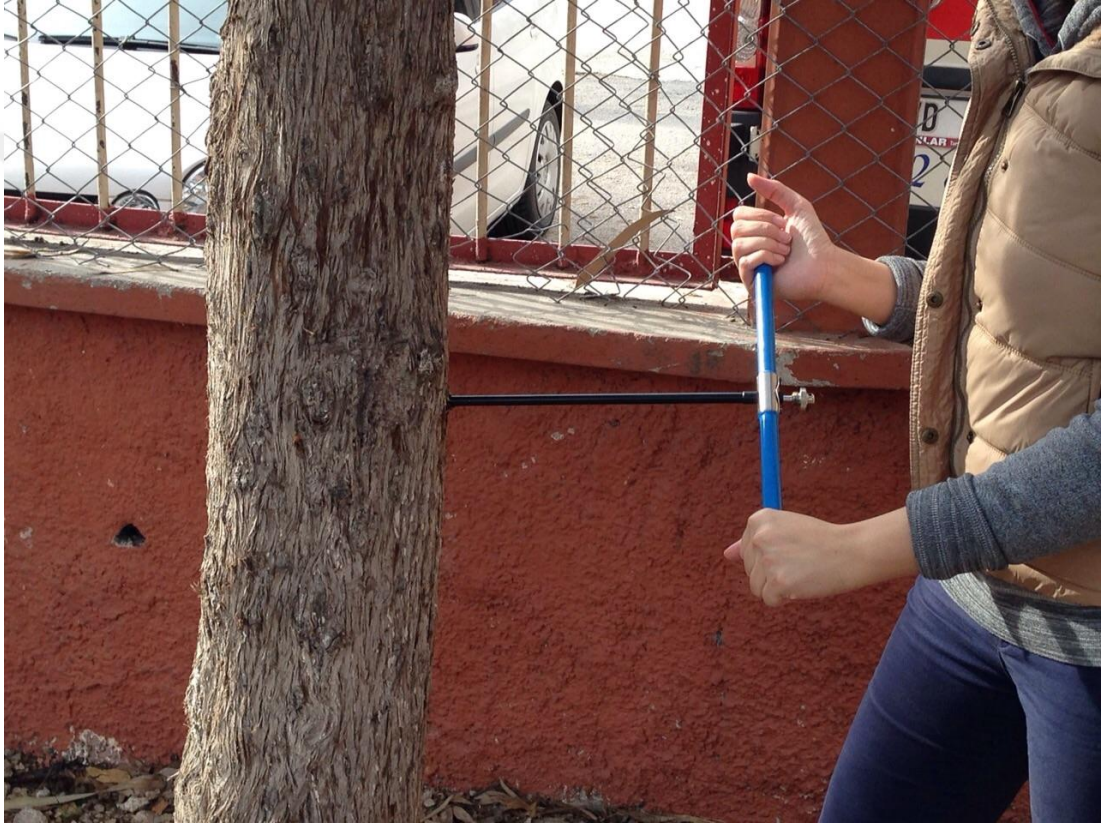
Şekil 3.4 Artım burgusu ile örnekleme
