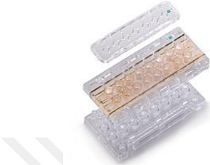
Şekil 3.4. CIM Plate 16, üç kısımdan oluşur. Yatayda 8 olmak üzere duplike olarak toplamda 16 kuyucuktan oluşmaktadır. En altta migratif bir ajanın yüklendiği alt tabla, orta kısımda örneklerin yüklendiği plak ve üst kapak mevcuttur.
