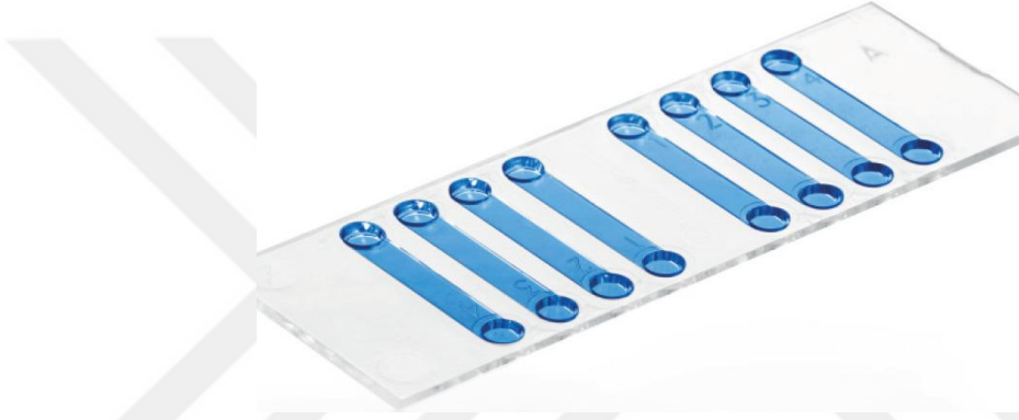
Şekil 3.1. Cedex XS Smart Slides, iki farklı yönden örnek yüklenebilen 8 kuyucuğa sahiptir.
