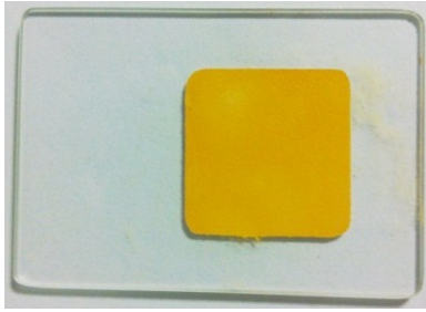
Şekil 3.5. XRD ölçümü için hazırlanmış örnek bir numune.
