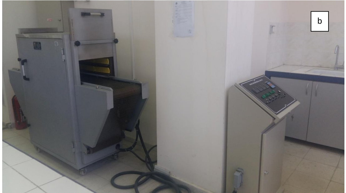
Şekil 3.2. Kızılötesi kabin ve kontrol paneli a) şematik gösterimi, b) IR kabine ait resim
