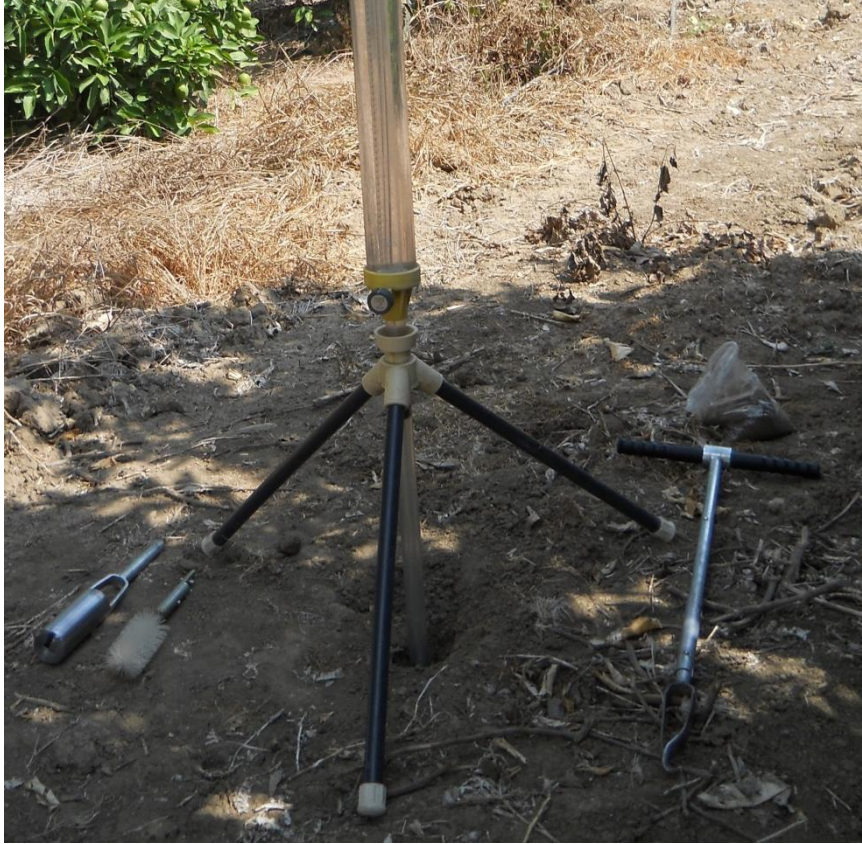
Şekil 3.10. Ölçüm kuyusuna yerleştirilmiş Guelph permeametre ve kuyu açmada kullanılan ekipmanlardan (burgu, silindir ve fırça) bir görünüm.
