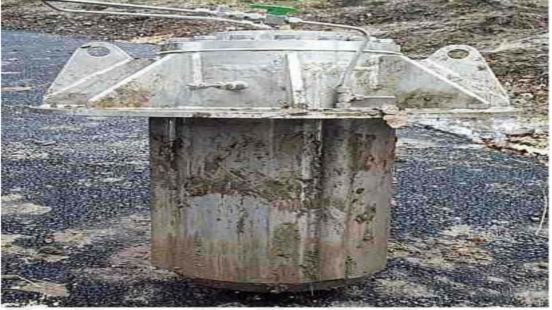
Şekil 2.3. Arazi tipi ıslak hava oksidasyon sistemi [Gizir vd., 2006].
