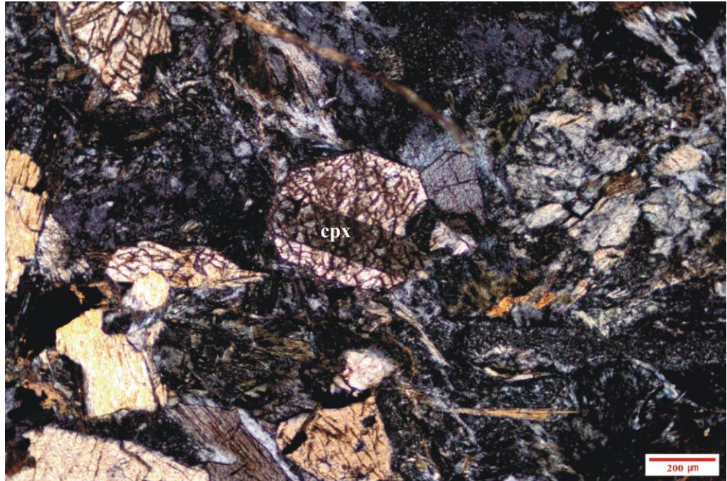
Şekil 5. 1. 6. Çift yönde dilinim (89-90°) gösteren özşekilli klinopiroksen; Diyabaz; subofitik doku; cpx:klinopiroksen; Çift nikol
