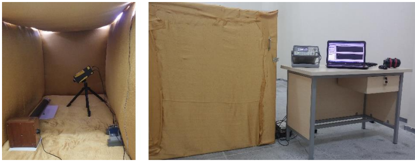
Şekil 4. 1. Akustik modal analiz test düzeneği
