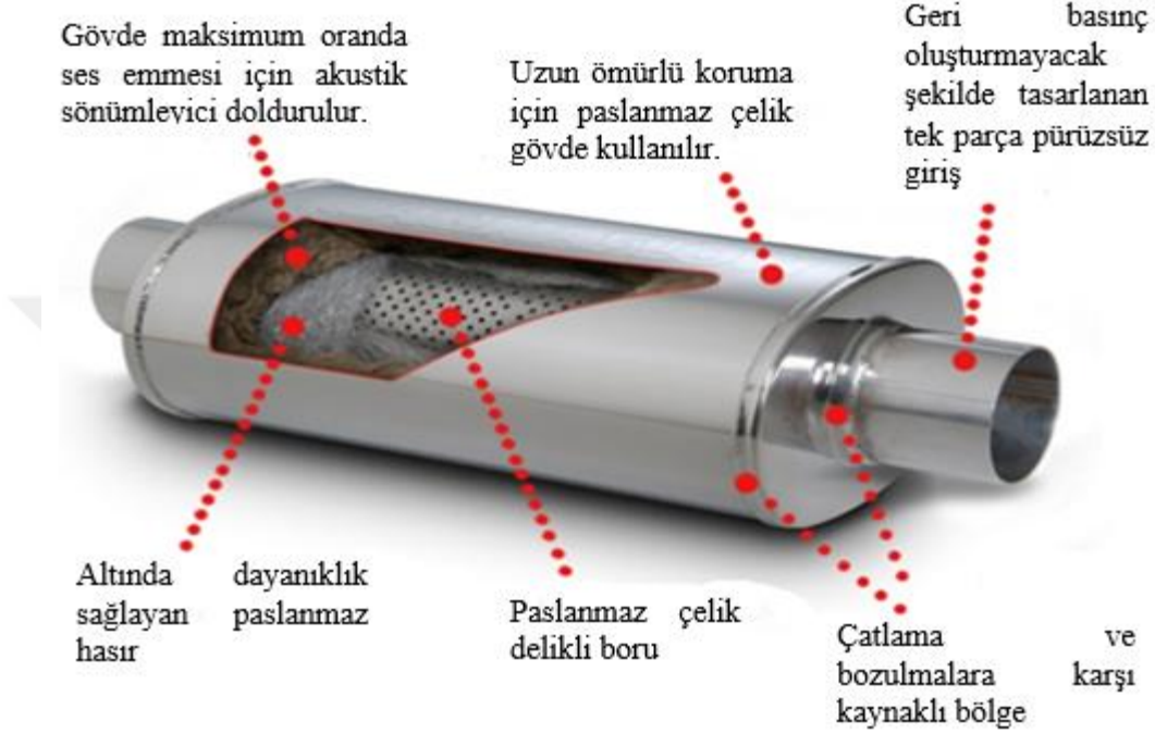
Şekil 3. 4. Hibrit susturucu örneđi
