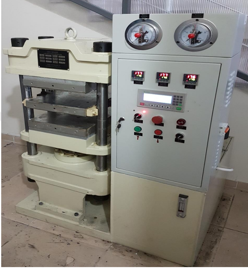
Şekil 3.2. Vulkanizasyon işleminin gerçekleştiği hidrolik pres cihazı
