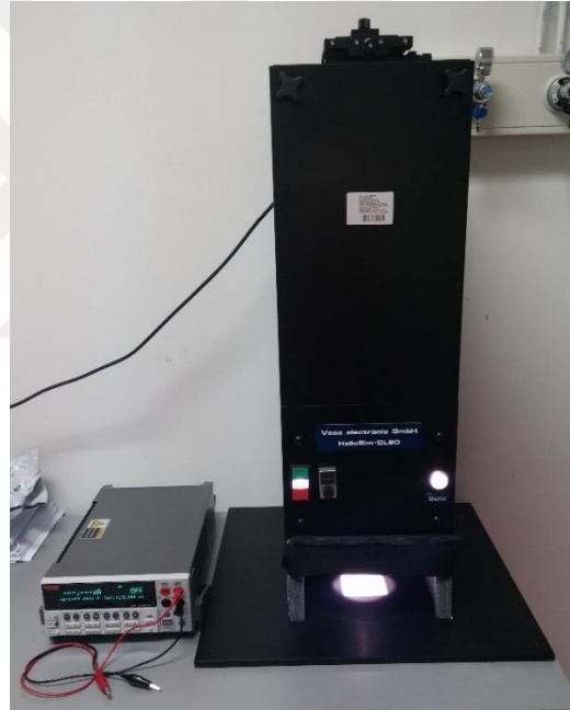
Şekil 4.14. Hazırlanan biyo-fotovoltaik güneş pillerinin ölçümünde kullanılan solar simülasyon cihazı.
