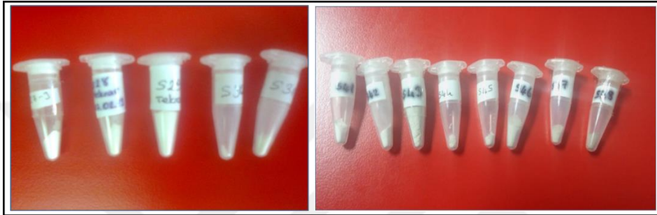
Şekil 4.15. Sırasıyla süreye bağlı olarak sentelenen ZnO nano tozlar ve Mn katkılı ZnO nano tozlar.
