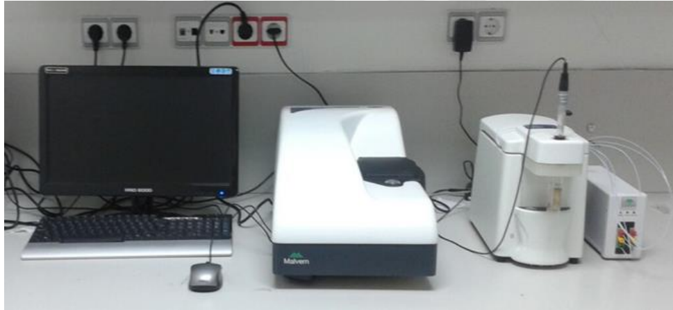
Şekil 4.11. Metal oksit nano partiküllerin zeta potansiyel ölçümlerinde kullanılan zetasizer cihazı.
