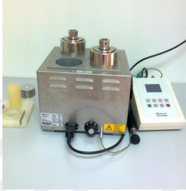
Şekil 4.3. Nano tozların sentezinde kullanılan hidrotermal sistem (Otoklav).
