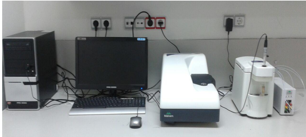
Şekil 5.22. Sentezlenen nano partiküllerin ölçümlerinin alındığı Zeta Potansiyel Ölçüm Cihazı.
