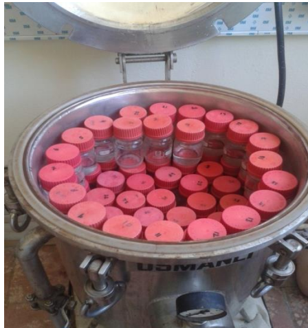
Şekil 3.2. Kırmızı kapaklı TP örneklerinin otoklava dizilişi.
