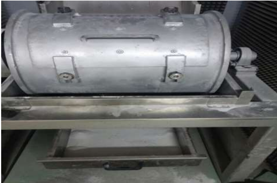
Şekil 4. 1. Agregaların aşınma kaybı değerlerinin bulunmasında kullanılan Los Angeles Aşınma Kaybı Aleti
