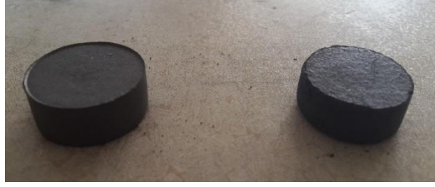
Şekil 3.17. Ön şekillendirme sonrası fren balata numunelerinin görünümü
