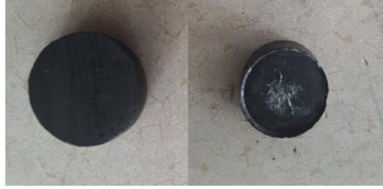
Şekil 3.19.Sıcak pres ile imal edilen balatalar
