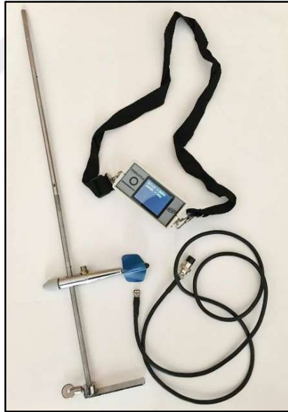
Şekil 3.3. Akarsu hızı ölçümlerinde kullanılan cüce muline cihazı.
