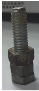
Şekil 4.43. Kum içerisinde vida deneylerinde kullanılan metal vida
