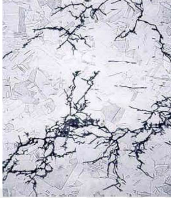
Şekil 2.7. Gerilmeli Korozyon Örnek Mikroyapı Görüntüsü
