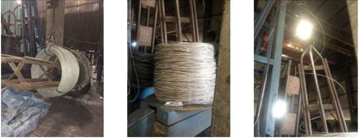
Şekil 3.5. Filmaşinin Tel Çekme Makinasına Beslemesi Öncesi Yapılan İşlemler
