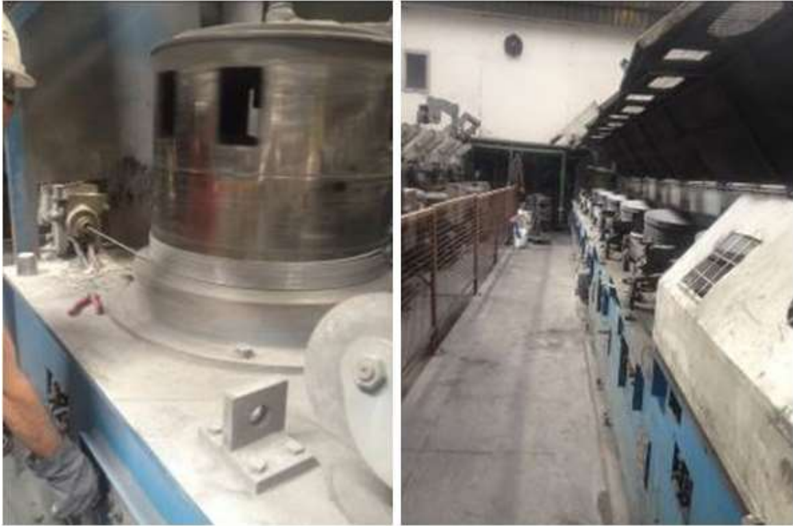
Şekil 3.6. Tel Çekme Makinası 1. Kafadan Geçen Tel ve Tel Çekme Makinası Görünüm
