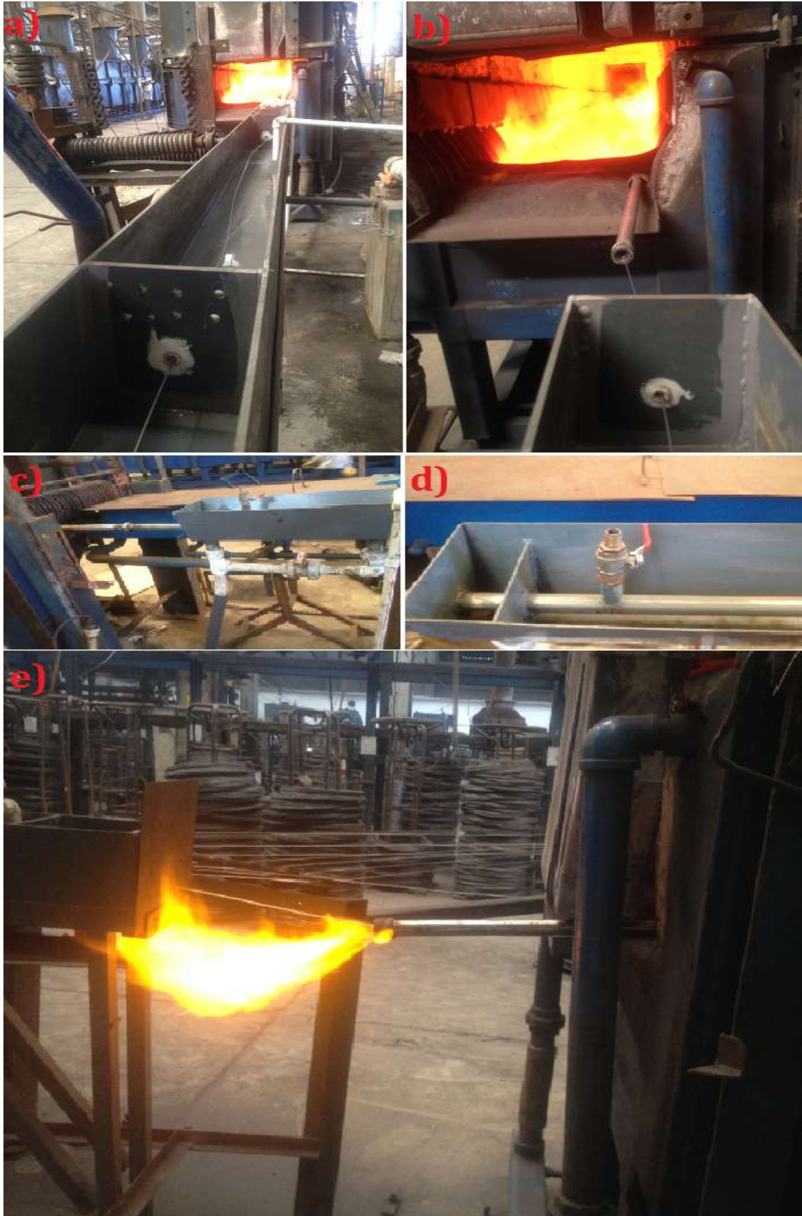
Şekil 3.18. a) Ön Temizlik Ünitesi b) Telin Fırına Girişi c) Telin Soğuma Ünitesi d) İnert Ortam Gaz Girişi e) İnert Ortam Gazının Tel Giriş Kısmında Gösterdiği Yanma
