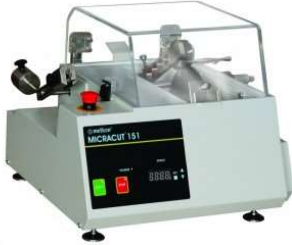
Şekil 3.7. Metkon Microcut 151 Hassas Kesme Cihazı
