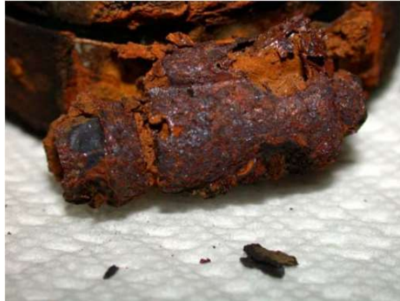
Şekil 2.9. Galvanik Korozyon Örnek Görüntüsü
