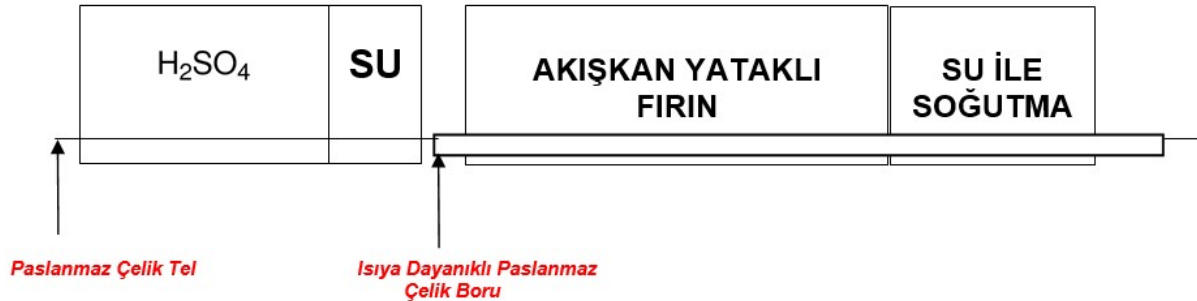
Şekil 3.17. Parlak Tavlama Prosesinin Basit Şematik Görüntüsü
