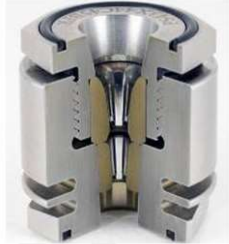
Şekil 3.4. Tungsten Karbür Basınç Haddesi ve Basınçlı Hadde Sistemi
