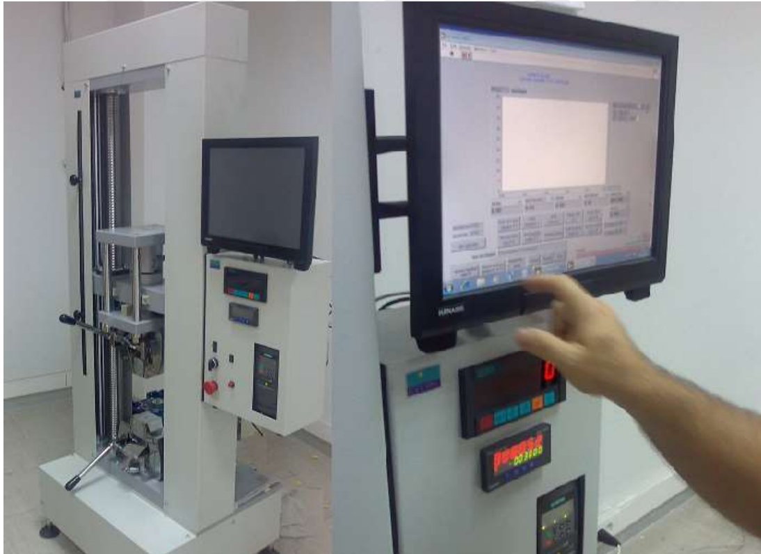
Şekil 3.14. Mares Marka 10 Ton Kapasiteli Çekme Test Cihazı ve Kontrol Paneli
