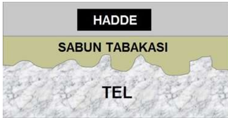
Şekil 3.3. Tel üzerine sıvanan sabunun hadde geçişi sırasındaki görüntüsü
