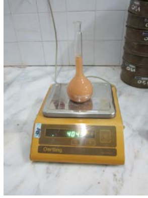
Şekil 4.8. Tane birim hacim ağırlığının belirlenmesi için kullanılan piknometre
