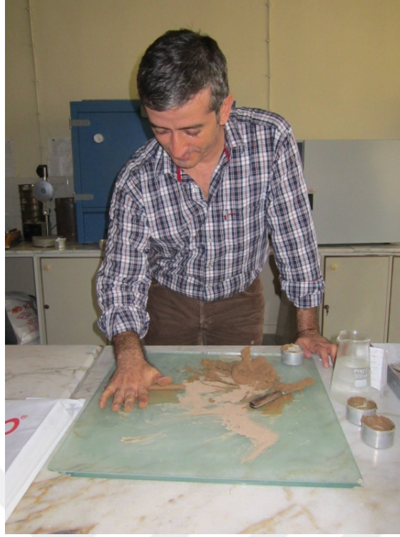
Şekil 4.9. Plastik limitin belirlenmesi deneyi uygulama çalışması
