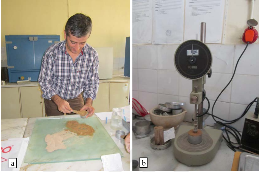
Şekil 4.10. Likit Limitin Belirlenmesi Deneyi
