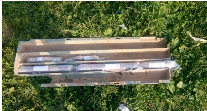
Şekil 4.34. SD-5 Sondajından alınan SPT örnekleri
