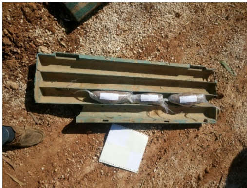
Şekil 4.28. SD-3 Sondajından alınan SPT örnekleri
