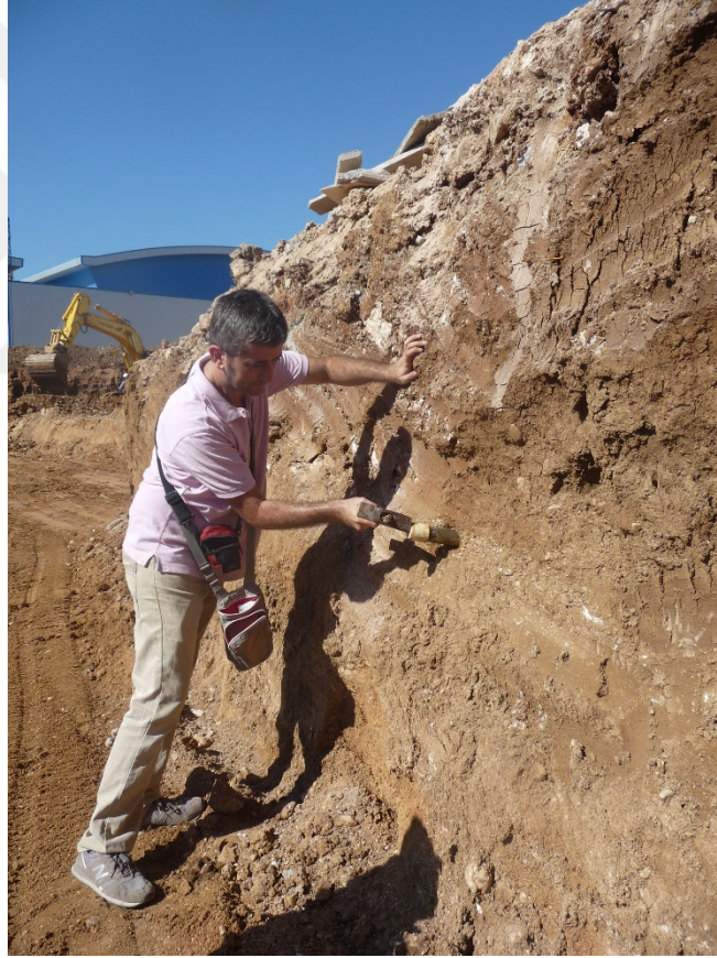
Şekil 4.18. Shelby tüpü ile örselenmemiş örnek alma çalışması
