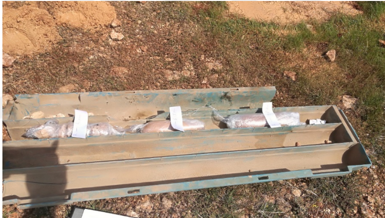
Şekil 4.23. SD-1 Sondajından alınan SPT örnekleri
