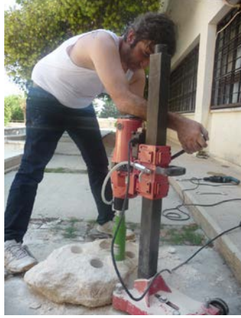
Şekil 4.14. Karbonat kabuktan alınan kalış numunelerinden karotiyerle örnek çıkarılması çalışması
