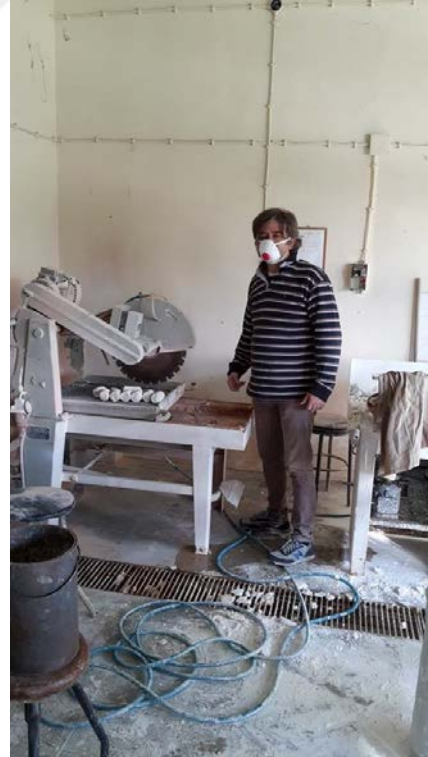
Şekil 4.16. Kalış karot örneklerinin deney için hazırlanması
