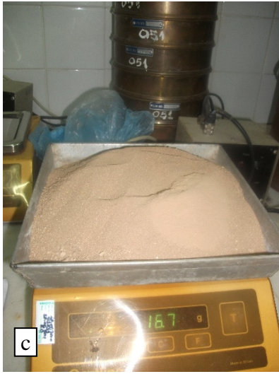
Şekil 4.11. Elek analizi deneyinin yapılması
