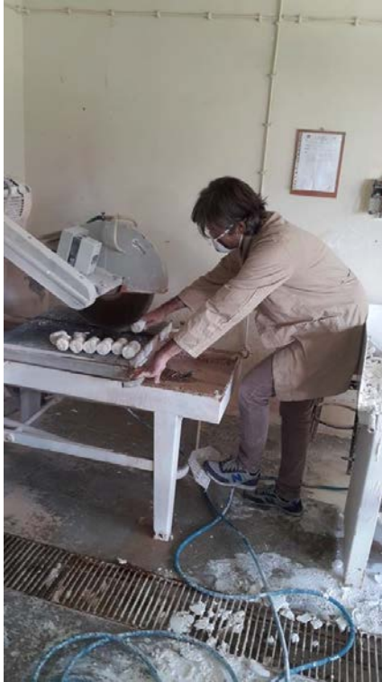
Şekil 4.16. Kalış karot örneklerinin deney için hazırlanması
