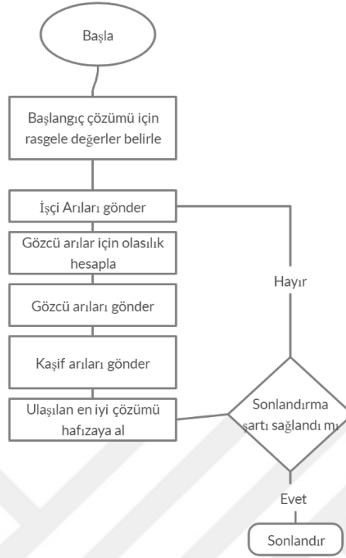
Şekil 3.21. YAKA algoritması akış diyagramı
