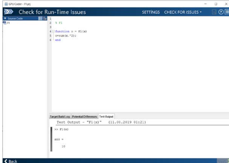
Şekil 3.5 : MATLAB üzerinde GPU Coder eklentisi ile YA algoritmasının testi için kullanılan F1 fonksiyonunun CUDA programlama diline dönüştürme işleminde fonksiyon testi
