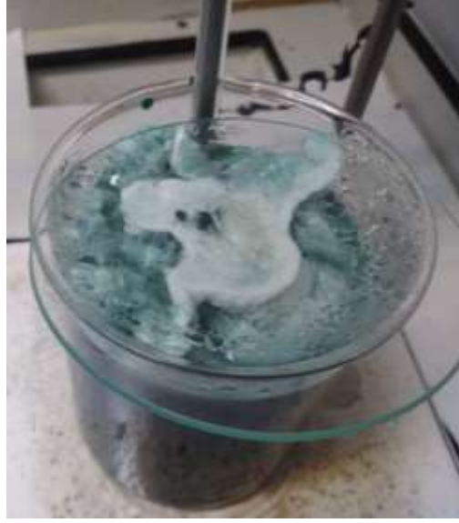
Şekil 3.4. Sodyum persülfat ile kimyasal oksidasyon denemelerinde oluşan koyu kıvamlı köpük.
