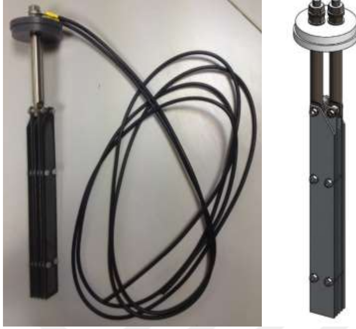
Şekil 3.1. 3 adet BDD anot ve 2 adet BDD katottan oluşan elektrot grubu (CONDIACELL® Stack Modell EAOP® Testkit).
