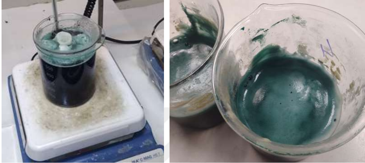
Şekil 4.2. Sodyum persülfat ile oksidasyon esnasında oluşan yoğun kıvamlı köpük (solda) ve deney sonundaki kalıntılar.
