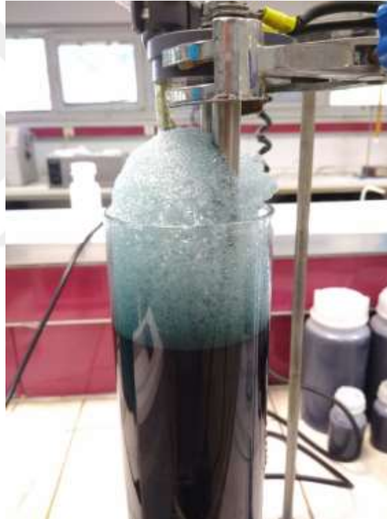
Şekil 3.6. Elektrooksidasyon işlemi esnasında karşılaşılan köpürme.
