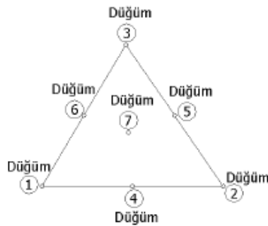
Şekil 10. Şekilde iki boyutlu dikdörtgen, iki üçgenli dikdörtgen, dörtgen elemanı ve dört üçgenli dörtgen elemanı tipi sonlu elemanlar da kullanılmaktadır.
