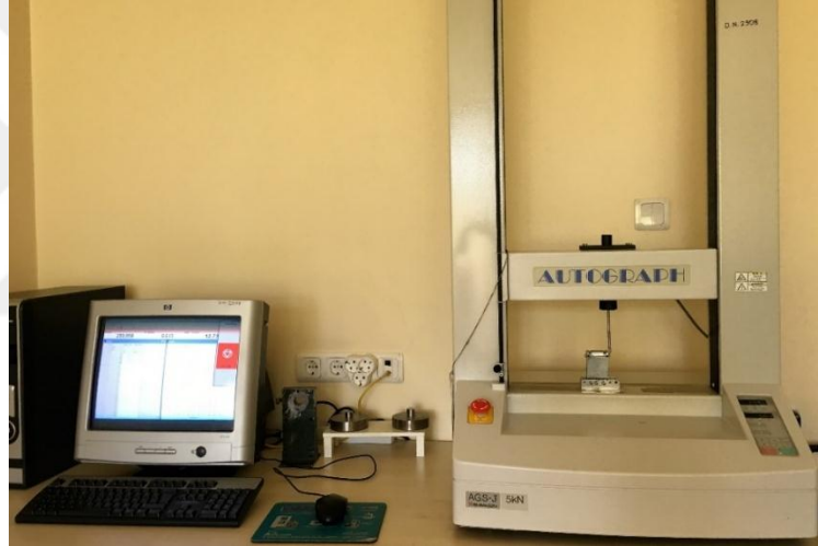
Resim 3.26: Universal test cihazı
