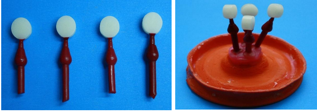
Resim 3.4: PMMA örneklere bağlanan döküm kanalları
