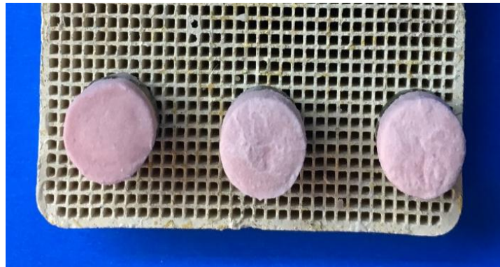
Resim 3.20: Dentin porseleni uygulanmış, fırına girmeye hazır örnekler
