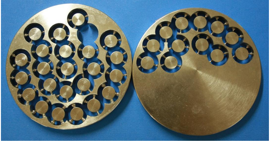
Resim 3.15: CAD/CAM Milleme yntemiyle retilen Co-Cr metal rnekle r
