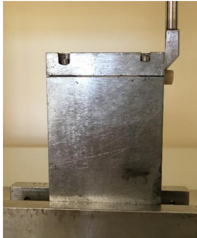
Resim 3.27: Makaslama testinin uygulanışı
