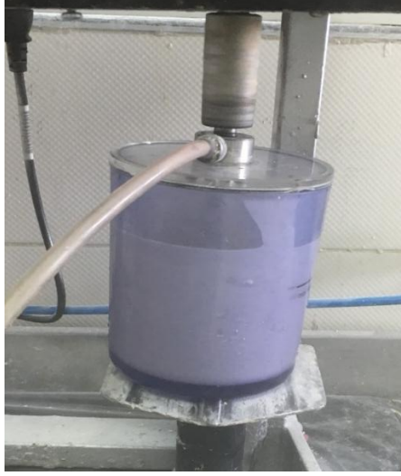
Resim 3.6: Revetmanın karıştırma makinesinde hazırlanması
