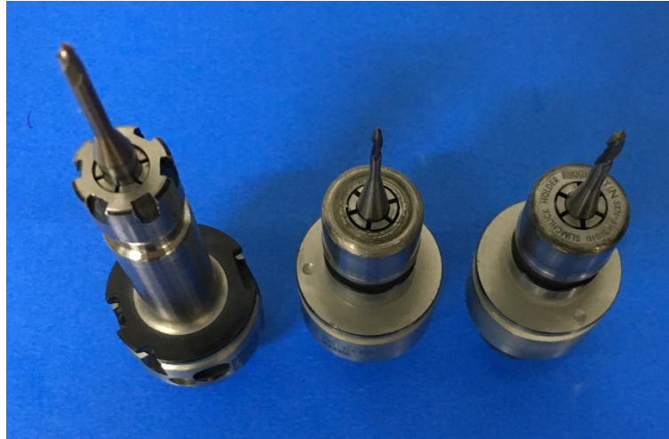
Resim 3.14: CAD/CAM Milleme yapılırken kullanılan kesici uçlar
