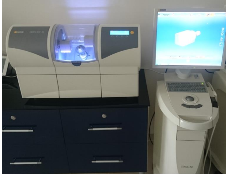
Resim 22: Cerec 3D - Cerec MC XL Premium Kazıma cihazı
