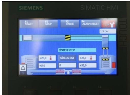
Resim 10: Termal siklus cihazı su tankları ve dijital ısı ayarları
