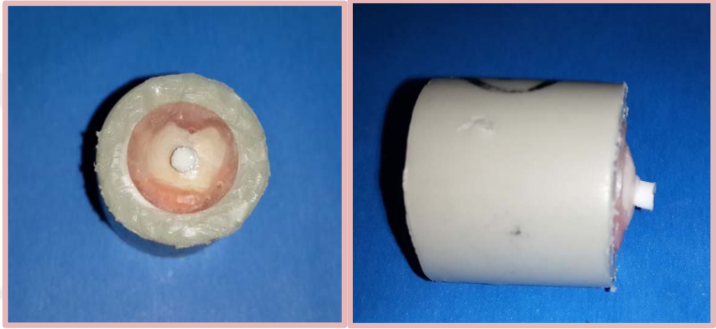
Resim 11.b. Fissür örtücü materyalden polimerizasyon sonucu elde edilen örnek
