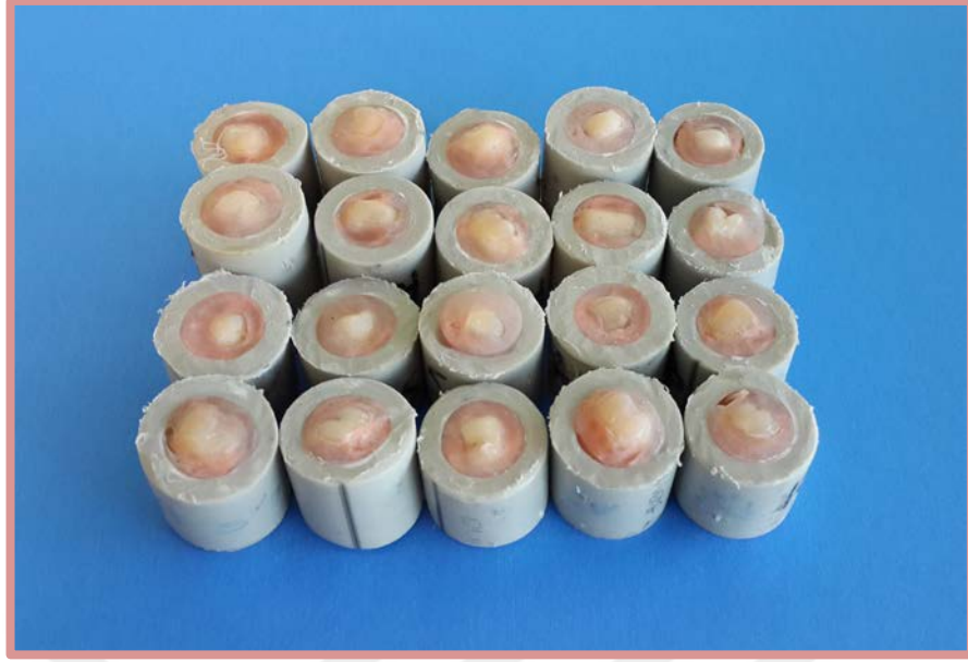
Resim 10. Bağlanma dayanımını ölçmek için hazırlanan örnekler
