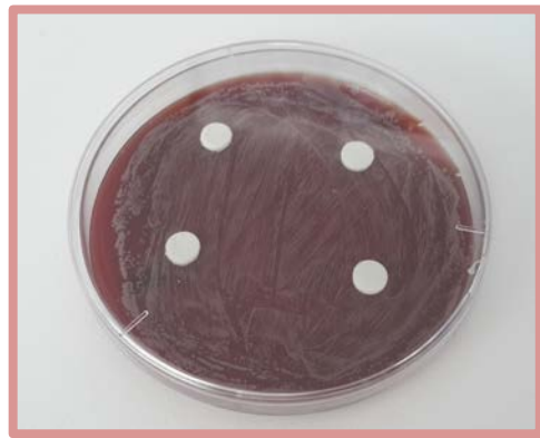
Resim 25. Hazırlanan örneklerin disk difüzyon yöntemi ile petri kutularına yerleştirilmesi
