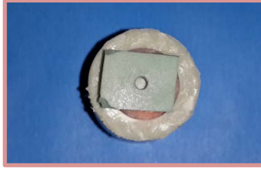
Resim 11.a. Örnek yüzeyine silindirik kalıpların yerleştirilmesi
