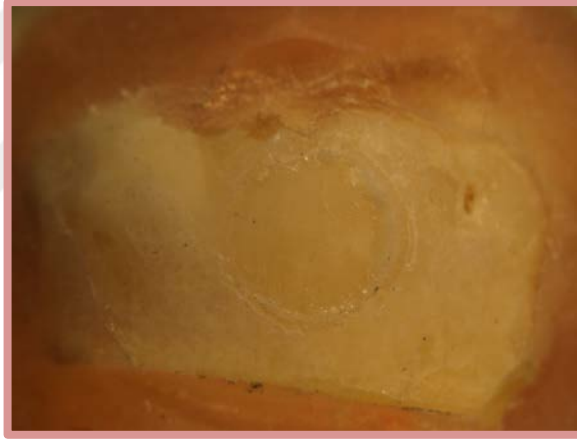
Resim 26. Adeziv tipte kırılma
