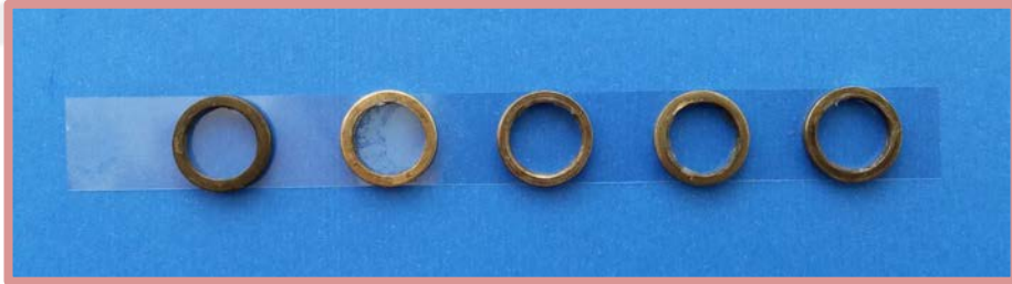
Resim 15. Örnekleri hazırlamada kullanılan metal kalıplar
