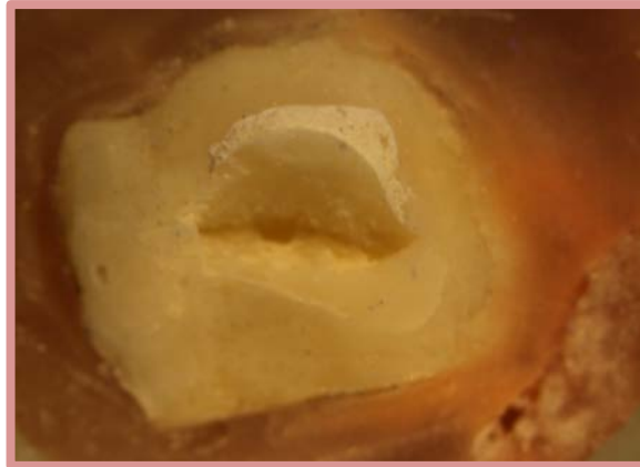
Resim 27. Koheziv tipte kırılma
