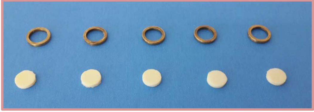
Resim 16.b. Mikrosertlik için hazırlanan fissür örtücü materyaller
