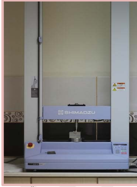
Resim 13. Üniversal test cihazı ( Shimadzu )
