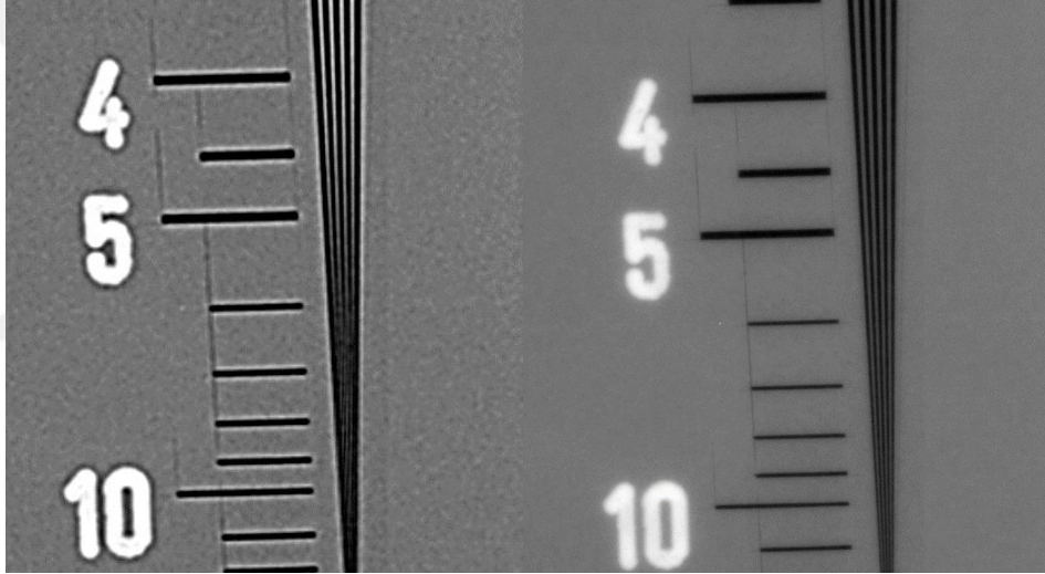
Şekil 5: Uzaysal rezolüsyonu ölçen iki farklı örneğe ait çift çizgi testi.
