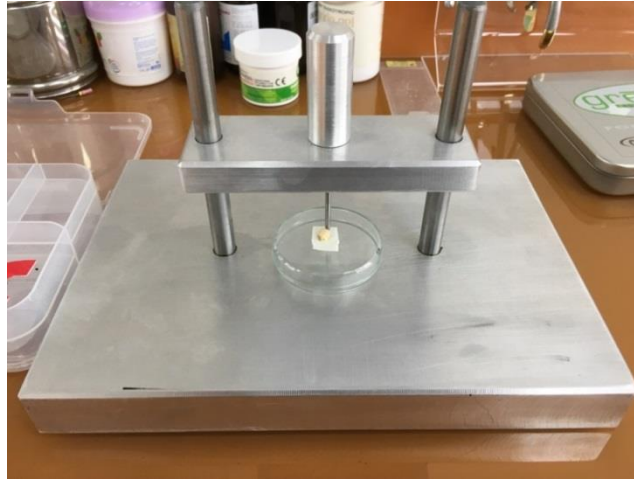
Şekil 3-5 Uygulanan kuvveti standardize etmek amacıyla hazırlanan 330gr ağırlığında alüminyum düzenek.
